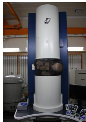
モノクロメータ搭載 低加速原子分解能分析電子顕微鏡 JEM-ARM200F
